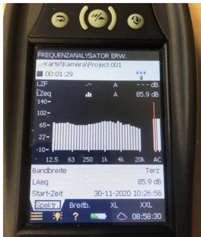
Abb. 22 Terz-Frequenzanalyse mit der Software des Messgeräts
