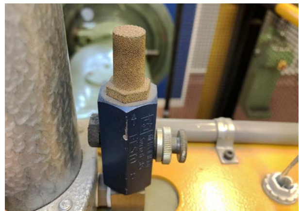
Abb. 26 Sintermetall-Schalldämpfer an pneumatischer Steuerung
